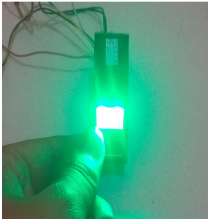
Gambar 4.16 Pengujian Modul Sensor Sidik Jari (Kondisi Aktif)
