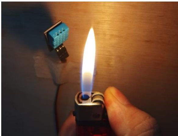
Gambar 23. Sensor Suhu DHT11 Dipanaskan
