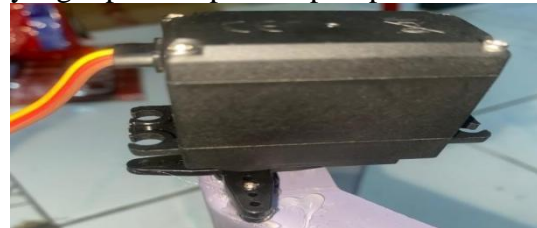
GAMBAR 4. Rangkaian Moto Servo MG996R
