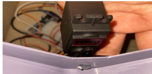
Gambar 13. Pengujian Terhadap Reaksi Pergerakan Moto Servo MG996R
