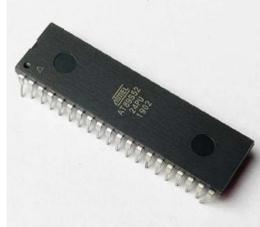
**Gambar 1. AT89S52-8051 Mikrokontroler**
